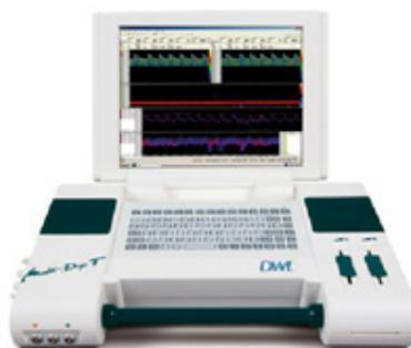
**Slika 3. Prijenosni TCD aparat za postoperacijski monitoring (K.B. Sveti Duh, laboratorijs za CV dijagnostiku)**
